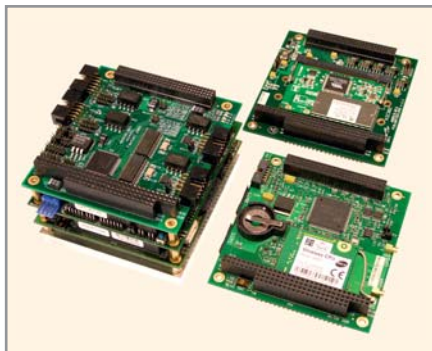
Рис. 4. Стековые модули PC/104-plus
