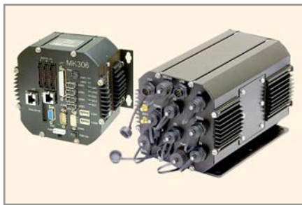
Рис. 1. Пример компьютеров со степенями защиты IP20 и IP65
