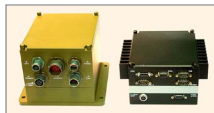
Рис. 12. Защищённые заказные компьютеры на базе стеков модулей PC/104 с модульной конструкцией корпуса IDAN и HiDAN (RTD, США)
